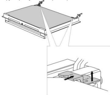
Ανασηκώστε ελαφρώς τα στηρίγματα στην αριστερή και δεξιά πλευρά της πόρτας (ένδειξη 1 στο στήριγμα) και τραβήξτε τα από τον υαλοπίνακα (ένδειξη 2 στο στήριγμα).
