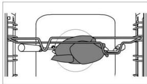
Περάστε το κρέας στη σούβλα και σφίξτε τις βίδες. Τοποθετήστε τη λαβή της σούβλας στο μπροστινό στήριγμα της σούβλας και εισάγετε την άκρη μέσα στο άνοιγμα στη δεξιά πλευρά του πίσω τοιχώματος του φούρνου (το άνοιγμα προστατεύεται με ένα περιστρεφόμενο κάλυμμα).
