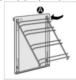
Τοποθετήστε τα καταλυτικά ένθετα στους οδηγούς. Το άνω μέρος των οδηγών πρέπει να τοποθετηθεί στα επάνω ανοίγματα “Α” των καταλυτικών ενθέτων.
