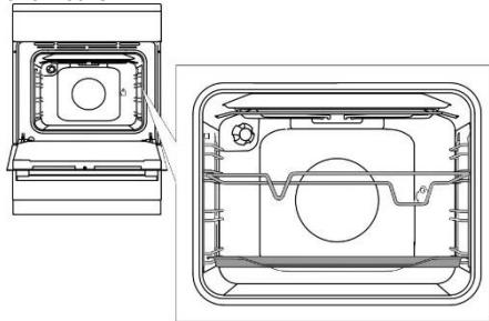
Τοποθετήστε το στήριγμα της σούβλας στον 3ο οδηγό, μετρώντας από κάτω, και τοποθετήστε το ρηχό ταψί στον κάτω (πρώτο) οδηγό για να χρησιμεύσει ως δίσκος αποστράγγισης.
